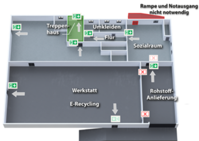
Abb. 11: Durch die dynamische Fluchtwegregelung konnte die ursprünglich geplante Rampe mit Notausgang entfallen
